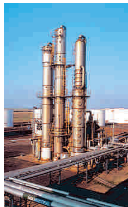
Colunas de destilação de álcool, Sertãozinho (SP).
