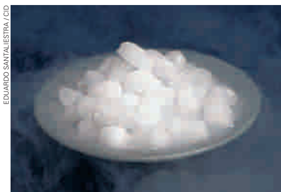
O gelo-seco ( \text{CO}_2 sólido) passa diretamente do estado sólido para o gasoso a 78^\circ\text{C} abaixo de zero.
