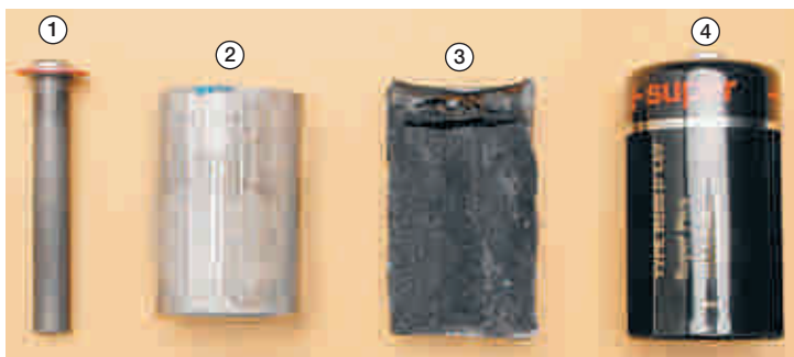
Principais elementos de uma pilha: ①, cilindro de carvão; ②, invólucro de zinco; ③, pilha vista em corte; ④, a pilha inteira.
