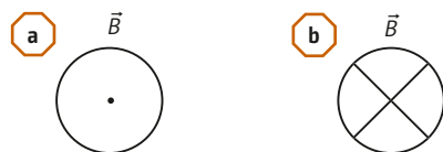
Figura 6.13 Representação dos sentidos do campo magnético em um fio reto e longo.
