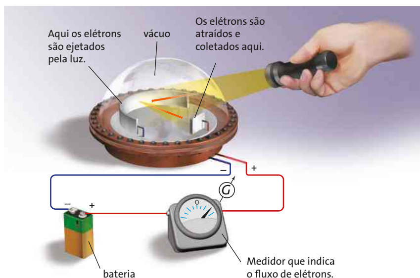
Figura 9.15 Representação (sem escala e em cores fantasia) do experimento do efeito fotoelétrico.
