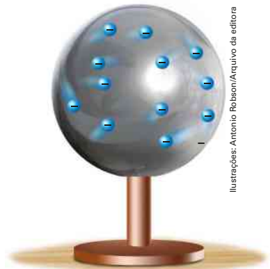
Figura 5.2 Movimento dos elétrons livres de um corpo sem que ele esteja submetido a uma ddp .
