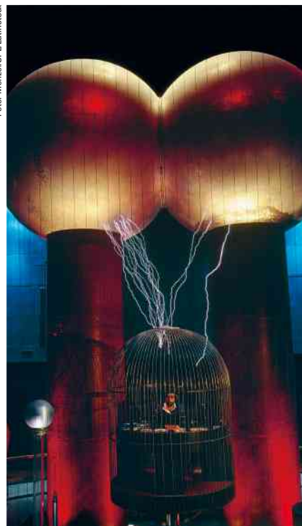
Figura 5.5 Pessoa no interior de uma gaiola de Faraday, que é submetida a descargas elétricas provocadas por geradores eletrostáticos. Repare que a pessoa não é atingida por nenhuma descarga elétrica.
