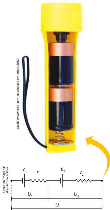
Figura 3.9 Associação de duas pilhas em série e a respectiva representação esquemática.
