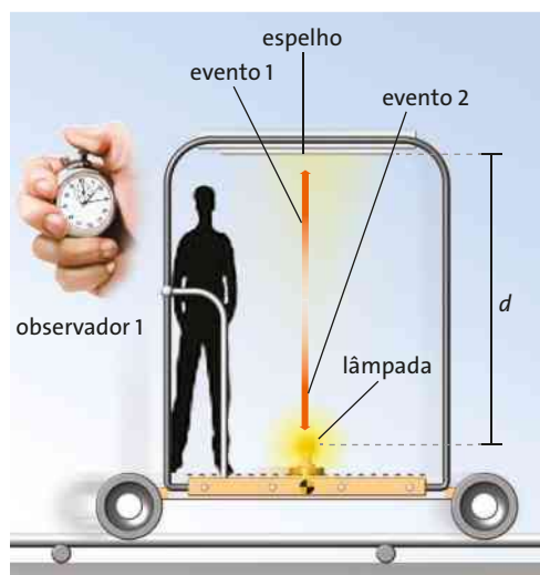
Figura 9.5 Pulso luminoso indo ao espelho e voltando à lâmpada, visto pelo observador no carrinho.
