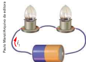
Figura 2.20 A corrente elétrica é a mesma nas duas lâmpadas associadas em série.
