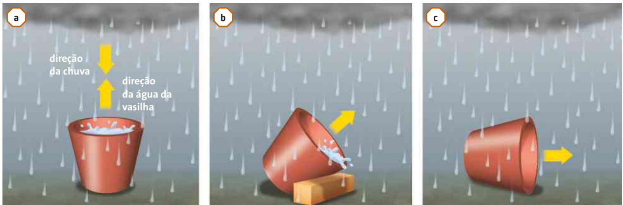
Figura 7.7 Representação da variação na captação de água pela vasilha. O mesmo se aplica à variação do fluxo magnético em uma área.
